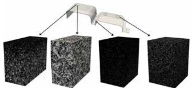
Abb: Berechnete Gefügestruktur einer Filmscharnierbox aus Polypropylen, Quelle: Institut für Kunststoffverarbeitung
