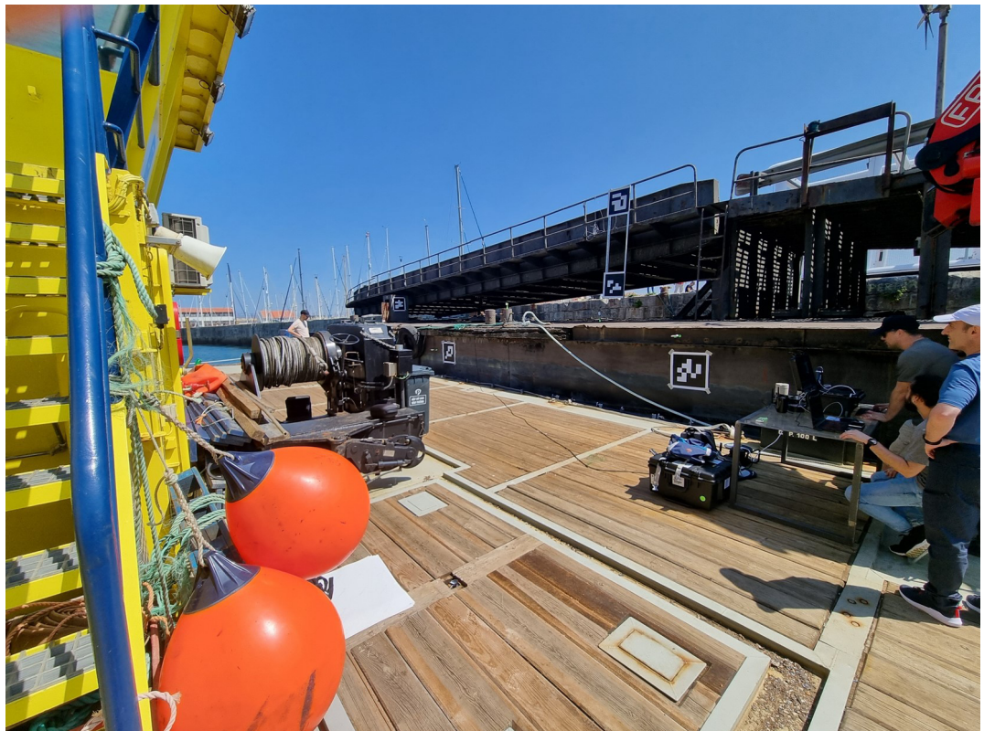
Abb. 5.11: Ziel des EU Projektes BugWright2 ist die Entwicklung teilautonomer Roboter, die die äußeren Containerschiffswände auf Schäden absuchen. Abgebildet ist eine Laderampe welche als Versuchsobjekt im Juni 2023 in Porto (Portugal) genutzt wurde. An die Schiffswand wurden QR-Code ähnliche Marker angebracht, welche später zur Orientierung eines Quadropters und der AR-Brillen verwendet wurden.
