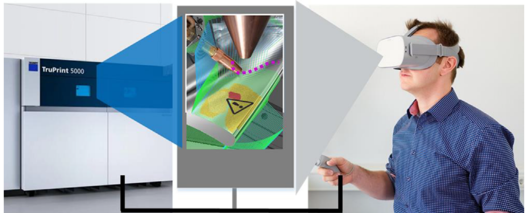
Abb. 4.16: Konzeptbild der Projektidee von VITAMINE_5G. Links ist eine Produktionsmaschine für die additive Fertigung dargestellt, bei der die Möglichkeiten zum Einblick in den laufenden Prozess technisch limitiert sind. Auf der rechten Seite ist ein exemplarischer Prozessexperte abgebildet, der mittels VR-Hardware sich immersiv mit dem Prozess und den Daten beschäftigen kann. In der Mitte ist ein Beispiel einer visuellen Darstellung von ortsaufgelösten Informationen in der virtuellen Welt zu sehen.
